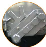
**Dupla Transmissão Lateral de engrenagens,** para desacelerar o rotor, para poder reduzir o desgaste de dentes
