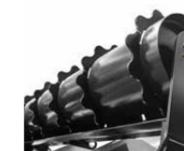
2 **Rolo de apoio com acionamento hidráulico** com raspador para permitir ao rolo trabalhar em solos úmidos
